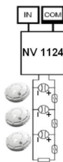
шлейф пожарных двухпроводных извещателей
